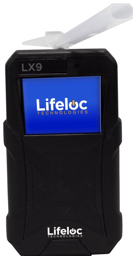
Siendo un equipo diseñado para su fácil manejo y entrega de resultados inmediatos en Pantalla a Color. Es dispositivo es visible en el interior o exterior sin importar si es en el turno diurno o nocturno. Ofrece indicadores del número de prueba, hora, vida de batería, bluetooth y GPS.
