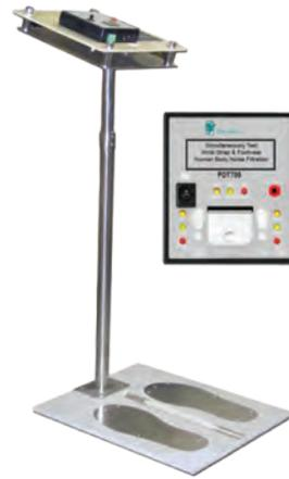
Con indicador LED para verificación del sistema de aterrizamiento
